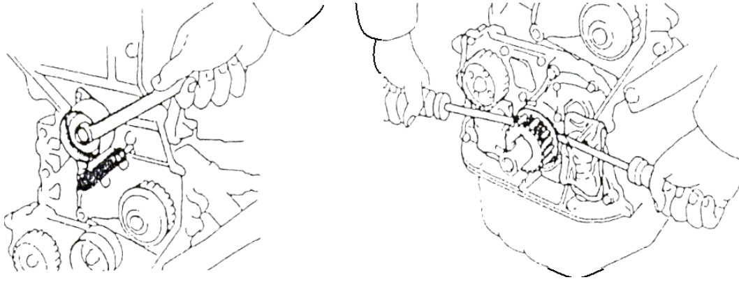
Hình 1.12: Tháo bánh tăng đờ cam và puli đai cam.
